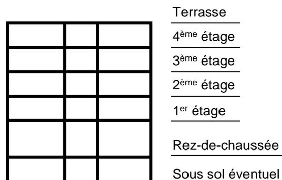
**Figure 2-4 :** Coupe verticale schématique d'un bâtiment d'habitation en béton armé avec le nombre maximal de niveaux prévus dans le domaine couvert par le guide RSPB
