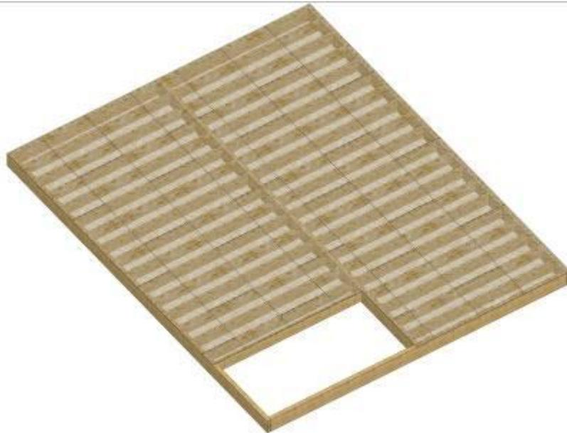
**Figure 6-23** : Perspective du diaphragme de plancher avec le calepinage des panneaux de plancher
