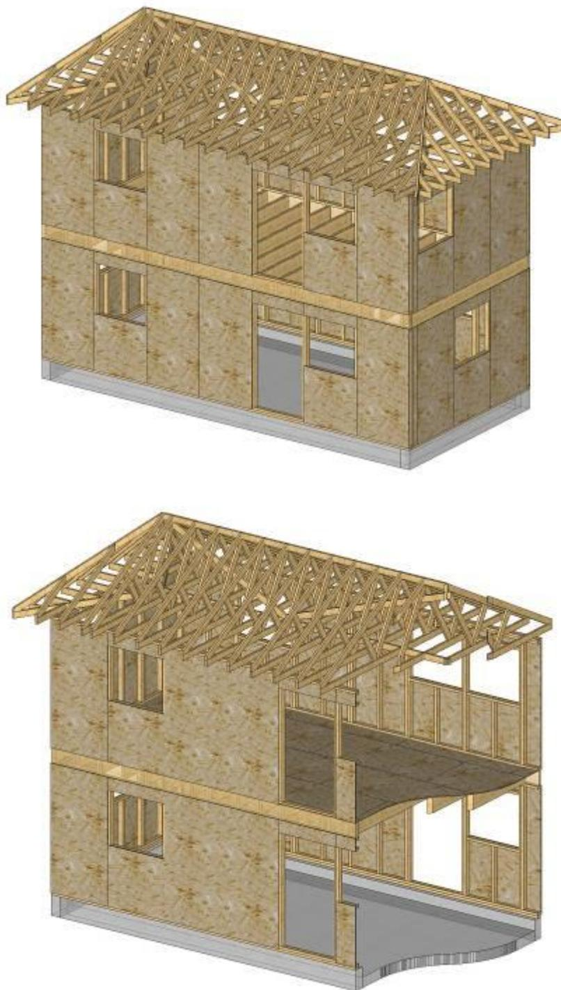
**Figure 6-21** : Perspective et coupe d'un bâtiment type en bois
